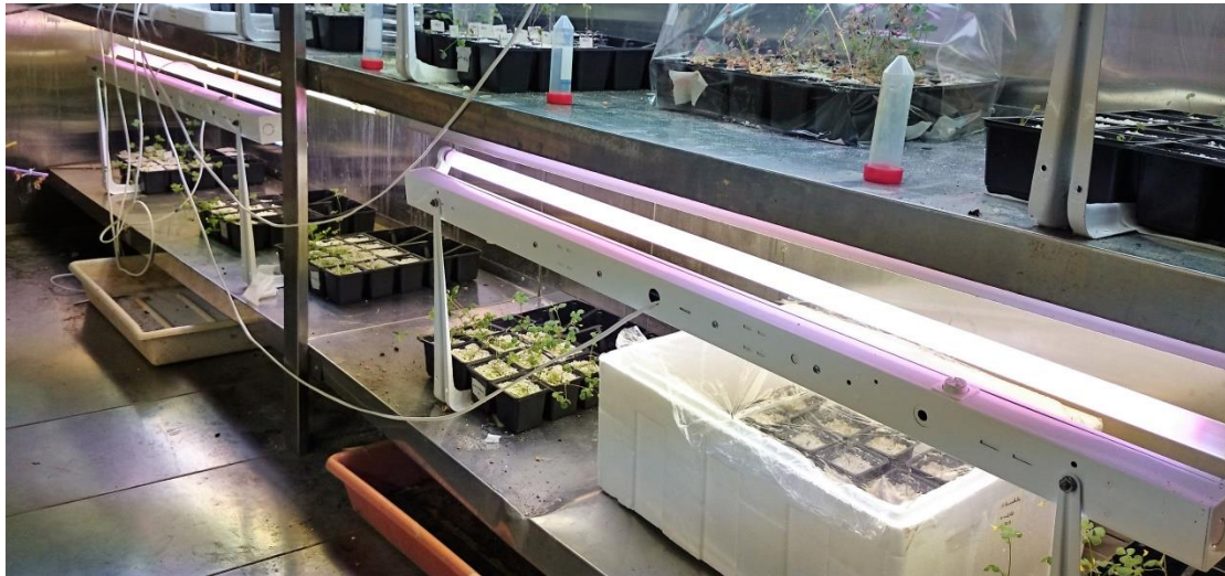
Εικόνα 3: Θάλαμος ανάπτυξης φυτών M. truncatula σε στερεό θρεπτικό υλικό (περλίτης/άμμος) με θερμοκρασία 20-25°C και φωτοπερίοδο 16 h φως/8 h σκοτάδι.
