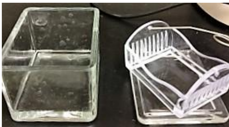
Εικόνα 9: Δοχείο και σκεύος συγκράτησης αντικειμενοφόρων πλακών που χρησιμοποιούνται στον RNA-RNA in situ υβριδισμό.
